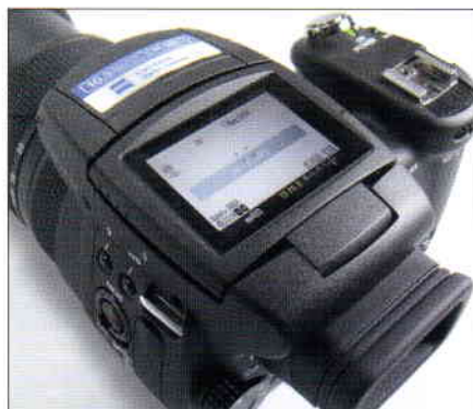
Az egyedi elhelyezésű és kialakítású LCD éppen kiforgatva és visszahajtva. Így felülnézeti keresőként funkcionál.
