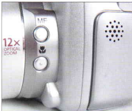
Az objektív tövében megbújó makro/szupermakro és manuális fókuszállításra kapcsoló minigombok.
